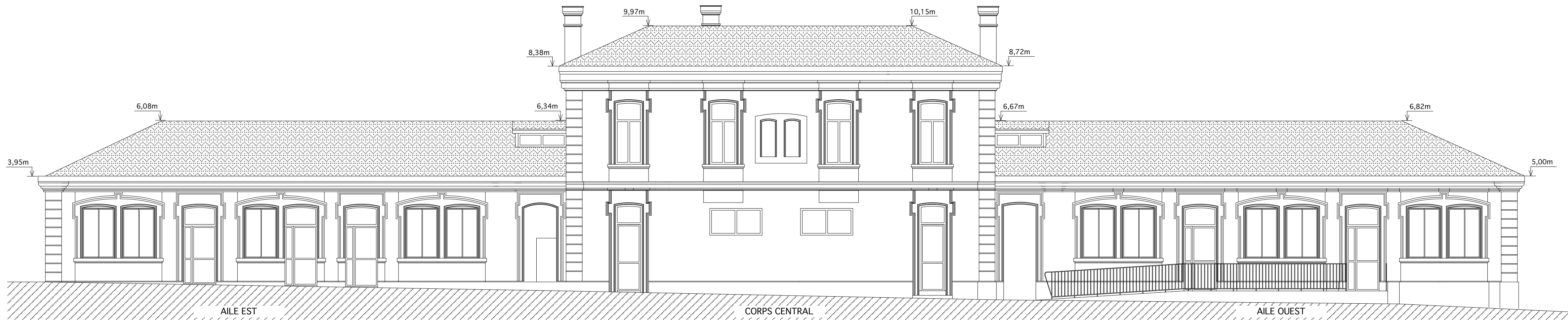
Indice 3 - Immeuble Mairie / Groupe Scolaire - Façade Nord - sur cour de récréation Détails - cf Façade Sud (Façade principale)
